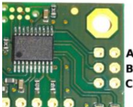
Bild 2: Einstellmöglichkeiten für den zusätzlichen Ausgang (ext. Clk.Out)
